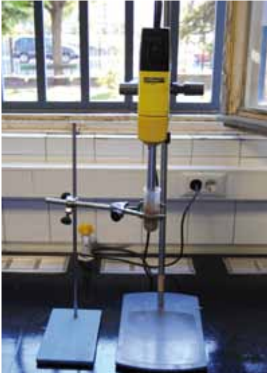
Fig. 6. Homogenización con ultraturrax Ika-Labortechnik DiAx 900.
