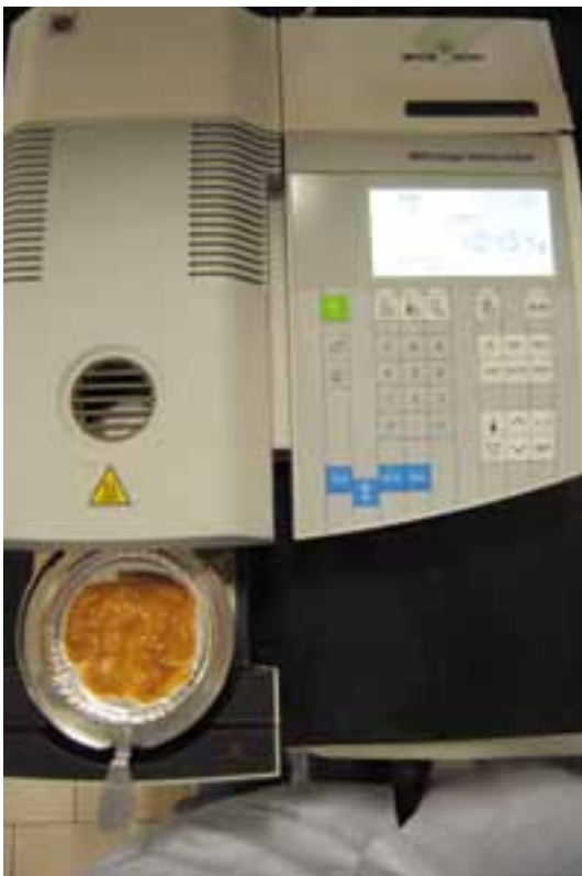
Fig. 7. Análisis de contenido acuoso con analizador halógeno Analyzer Moisture Halogen Hr73.
