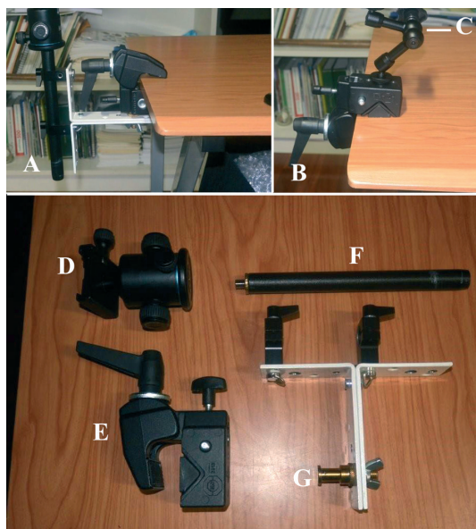
Fig. 3. A y B: Dos montajes diferentes de trípode de mesa. C: Brazo articulable para soporte de cámara de fotos. D: Cabezal de trípode para cámara. E: Pinza fijación a la mesa de Manfrotto Super Clamp 035. F: Un tubo de aluminio de 20 cm × 19 mm, para soporte de la cámara. G: Un adaptador de Manfrotto. Foto: C. Lavoise.
