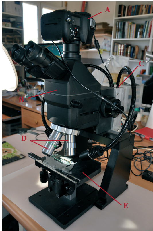
Fig. 14. "Macroscope". A: Cámara de fotos. B: Microscopio trinocular Mitutoyo Finescope FS-60 Series. C: Sistema de luz lateral con brazo flexible. D: Objetivos Mitutoyo. E: Platina aislada y desplazable. Foto: A. Paz.
