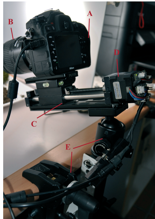
Fig. 2. A: Cámara de fotos Nikon D7100. B: Objetivo macro Nikon 60 mm. C: Carril deslizante. D: Motor paso a paso "Trinamic". E: Trípode de mesa. Foto: A. Paz.
